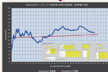
バイオフィウリングデータベース、就航プロフィール分析に、高頻度でサンプリングされた就航データを活用した推進性能解析結果から、CII シミュレーションを行います。同時に実際の燃料消費量と航海距離から CII モニタリングを実施し、CO<sub>2</sub> 排出状況の把握に役立てます。
