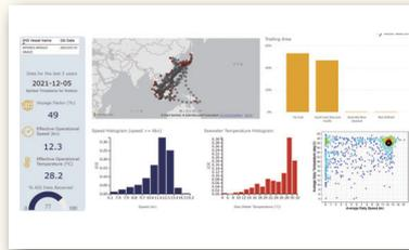
ご検討対象の船舶の詳細な就航プロフィールを AIS 情報などを収集して分析を行います。分析をとおして、就航率、平均船速、平均水温、航路などの特徴を可視化します。
